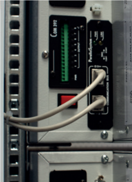
Параллельное подключение и плата контактов программируемых реле
